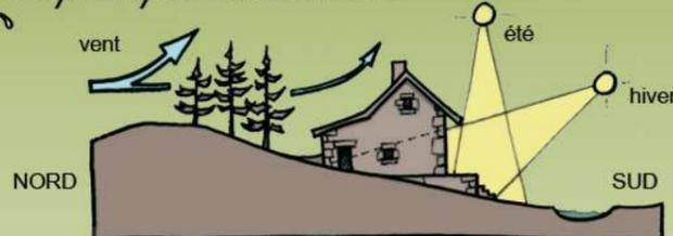
*De grandes fenêtres côté Sud permettent au soleil de réchauffer l'intérieur en hiver, comme dans une serre, et à la lumière d'entrer.*
