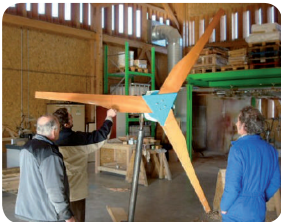
Eolienne en bois autoconstruite par Thomas Plassard et ses stagiaires.
