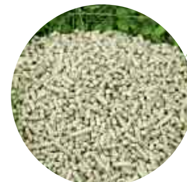
Les granulés sont élaborés à partir de sciures séchées et compressées en petits cylindres de 6 à 9 mm.
