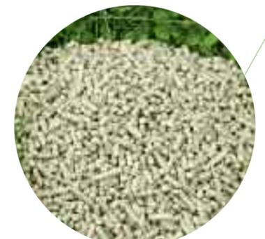
Les granulés sont élaborés à partir de sciures séchées et compressées en petits cylindres de 6 à 9 mm.
